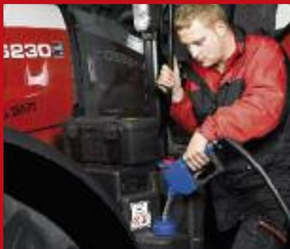
Wie funktioniert SCR: Es gibt zwei Tanks - einmal Diesel, einmal AdBlue. Die Abgasreinigung erfolgt nachgelagert in einem Katalysator. Die Abgase, die aus dem Motor kommen, werden mit AdBlue besprüht und es erfolgt eine chemische Abgasreinigung. Die Motoren können daher wesentlich leistungseffizienter arbeiten als bisher. Professionelle Landwirtschaft braucht wirtschaftliche Traktoren. Das Steyr ecotech-System ist genau darauf ausgelegt.
